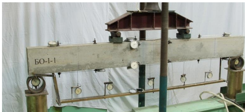
Рисунок 1 - Випробування звичайної балки серії БО-I-I
