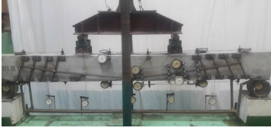
Рисунок 2 - Випробування підсиленої балки серії БПП-III-I
