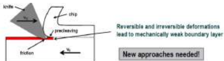
Рисунок 3 - Деформації поверхні обробки, що відновлюються і не відновлюються, внаслідок різання (потрібні нові дослідження).
