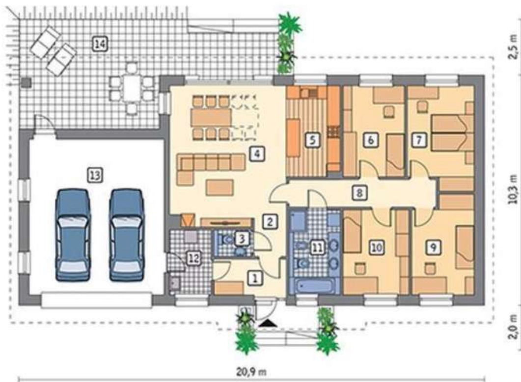
Rys. 1 Przykładowy rzut budynku w układzie horyzontalnym (projekt typowy „Dom oszczędny – wariant III”): 1 - wiatrołap, 2- korytarz, 3- WC, 4- pokój dzienny, 5- kuchnia, 6,7,9,10- sypialnia, 8- korytarz, 11-łazienka, 12-kotłownia, 13-garaż, 14- taras
