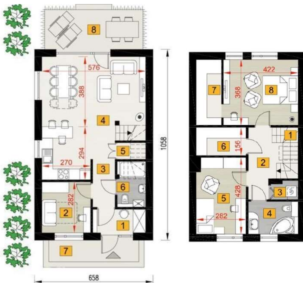
Rys. 2 Przykładowy rzut budynku w układzie wertykalnym (projekt typowy „Rezolutny 3N”); parter: 1 - wiatrołap, 2- gabinet, 3- hol, 4- pokój dzienny z aneksem kuchennym, 5- spiżarnia, 6- łazienka, 7- schody zewnętrzne do budynku, 8- taras; poddasze: 1- schody wewnętrzne, 2- korytarz, 3- pralnia, 4- łazienka, 5,8- sypialnia, 6,7- garderoba
