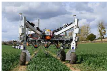
Rys. 24. Robot autonomiczny usuwający chwasty za pomocą prądu.
